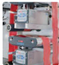
Standard ist eine automatische Bahnkantensteuerung mit integriertem Speißbüch. Für mehrbahnige Anwendungen wird eine zweite Bahnkantensteuerung angeboten.
