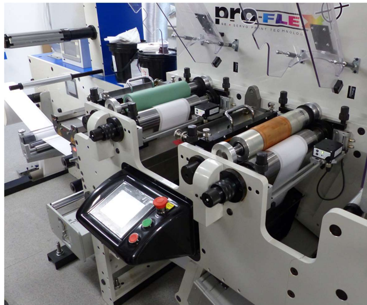
BILD 2 Die Proflex 250 SE verfügt über moderne Druckwerke mit Drop-in Druckzylindern
