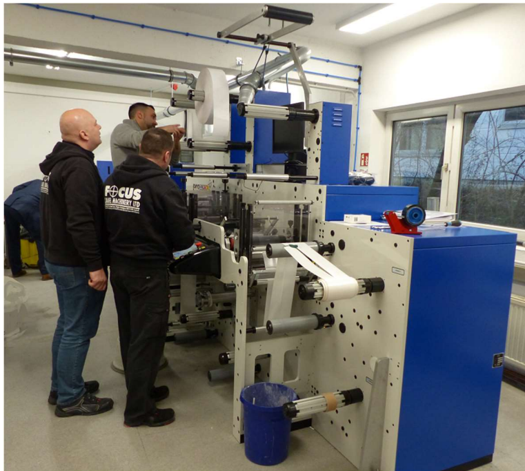
BILD 4 Die Proflex 250 SE bei Klingbeil verfügt über eine individuelle Sonderausstattung für die Produktion von Stanzteilen aus bis zu 4 Komponenten (Thomas Hugo, Mario Margiotta, Paul Stanley)
