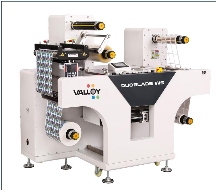
Die **DUOBLADE WS** Finisher stanzen, schneiden, laminieren, entfernen Matrix und schneiden längs in hervorragender Geschwindigkeit und Qualität.
