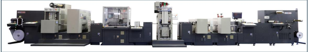
Bahnbreite 330 mm: Siebdruck - Heißfolienprägung flach und semirotativ - Stanze flach und semirotativ - Flexodruck - Offsetdruck - Laminiereinheit - Auswahl an Aufwicklungen - digitale Steuerung aller Funktionen
