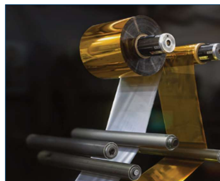
Kaltfolien-System zum Aufbringen von Folien-Motiven mit scharfen Konturen auf eine Lackschicht
